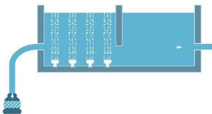
Diese dient einerseits dazu, die **Mikroorganismen abzutöten** (siehe 3.4 Desinfektion). Des Weiteren werden gelöstes **Eisen** und **Mangan** oxidiert, so dass sie in einem der beiden nachfolgenden Schritte (siehe 3.2 Flockulation und 3.3 Filtration) vom Rohwasser getrennt werden können.
