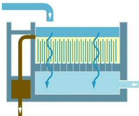
Bei Sand- und Kiesfilter werden die suspendierten Feststoffteilchen durch **physikalische Vorgänge** (große Teilchen können kleine Durchgänge nicht passieren).
